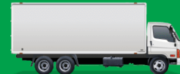
10-WHEEL TRUCK • 14 TON • 31 M 3 LxWxH: 600x230x230 CM
