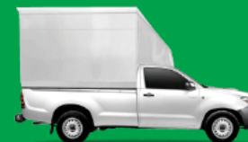
BOX TRUCK • 1.5 TON • 6.9 M 3 LxWxH: 220x150x210 CM
