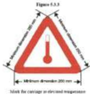
Tanda harus berupa segitiga sama sisi. Warna tanda harus merah. Minimum dimensi sisi harus 250 mm. Jika dimensi tidak ditentukan, semua fitur harus dalam perkiraan proporsi dengan yang ditunjukkan. Untuk tangki-wadah atau tangki portabel dengan kapasitas tidak lebih dari 3.000 liter dan dengan luas permukaan yang tersedia tidak cukup untuk membubuhkan tanda yang ditentukan, dimensi minimum sisi dapat dikurangi hingga 100 mm.
